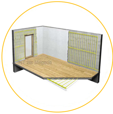
Modell mit Fußboden- und Wandheizung
